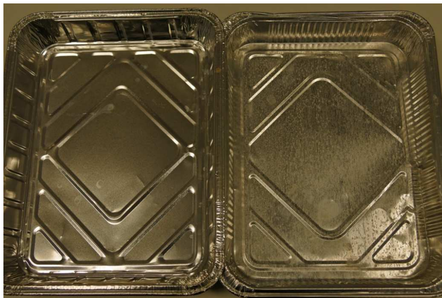
Abbildung: Blanke Al Menüschalen nach Kontakt mit Lebensmittelprobe Nr. 14: Menüschale 1.1. (links) keine sichtbaren Korrosionsschäden und Menüschale 2.1 (rechts) mit korrodierter innenseitiger Oberfläche
