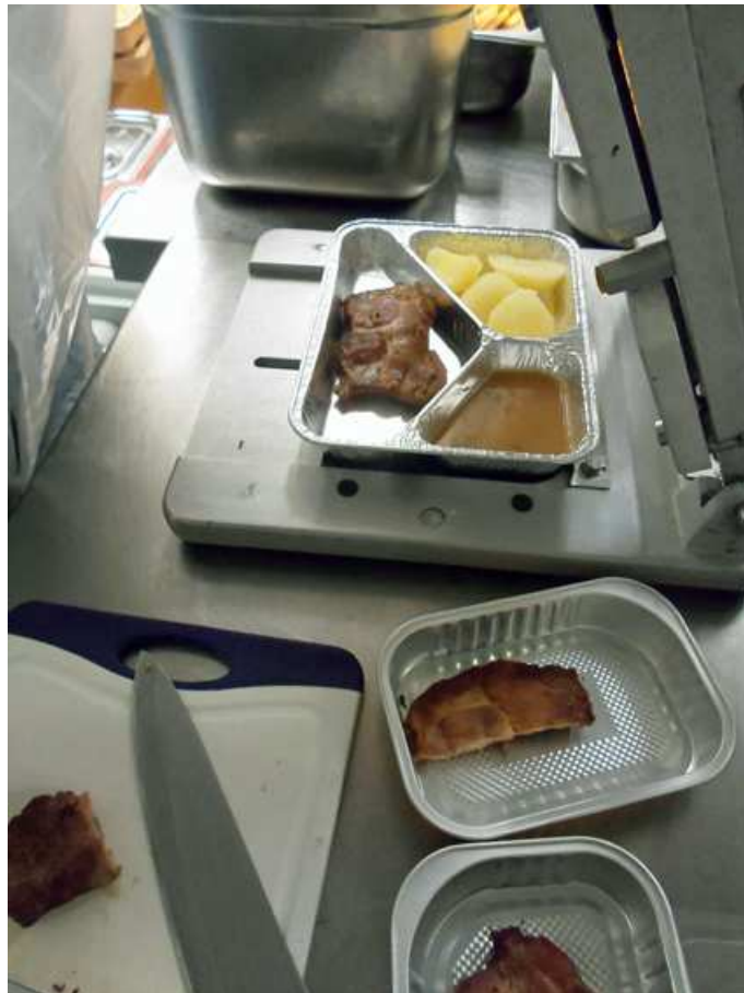
Abbildung: Befüllen und verschließen der Aluminium-Menüschalen
